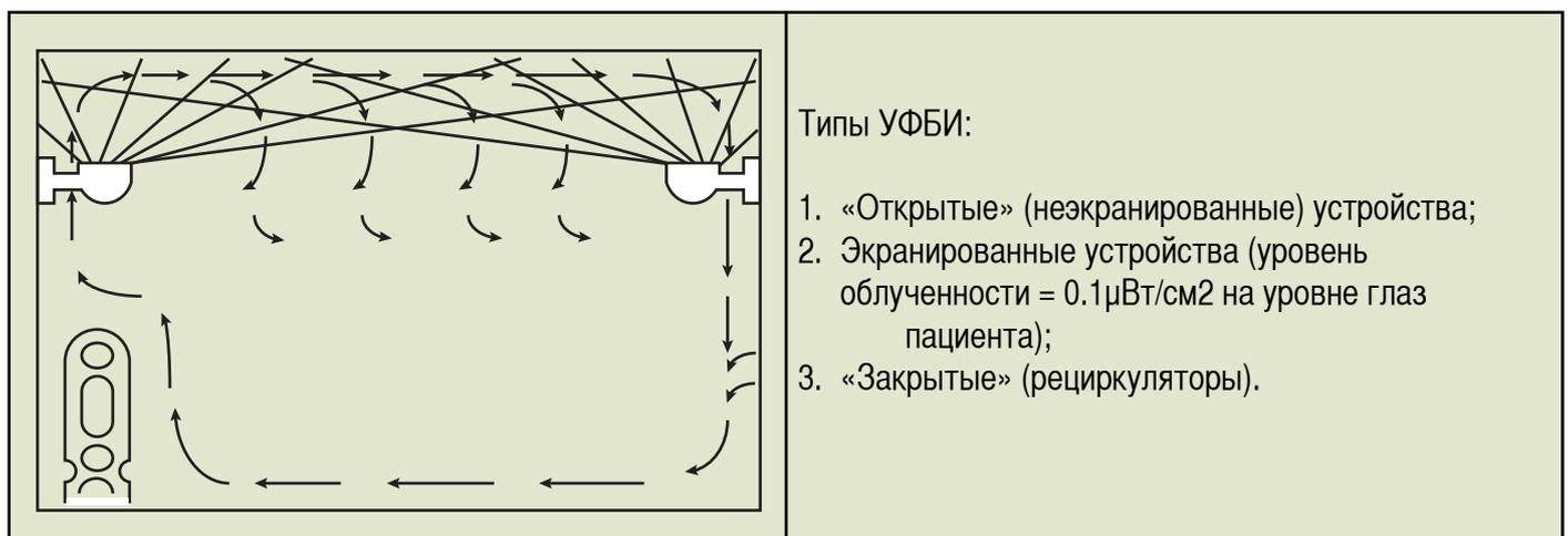
Отражатель бактерицидного облучателя «закрытого» типа должен направлять бактерицидный поток лампы в верхнюю полусферу помещения так, чтобы никаких лучей, как непосредственно от лампы, так и отраженных от частей облучателя, не направлялось под углом, меньшим 5 град. вверх от горизонтальной плоскости, проходящей через лампу.
