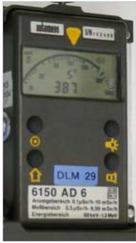
Gerät zum Kontaminationsnachweis (Anzeigeseite, Ansicht von oben); der Anzeige von knapp 400 lps entspricht eine Hautkontamination von etwa 10 Bq/cm<sup>2</sup>, bei deren Unterschreitung weitere
