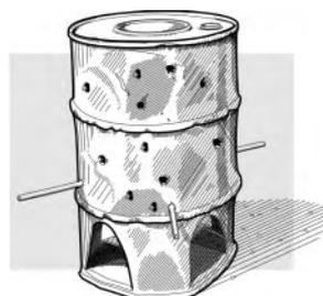
9 Découper et détacher la moitié du fond du fût. Attacher la moitié découpée à l'autre moitié en place par un fil de fer, et y fixer une boucle de fil de fer qui servira de poignée au couvercle.
