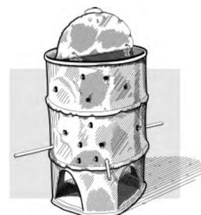
10 Déposer la plaque sur les barres à l'intérieur du fût.
