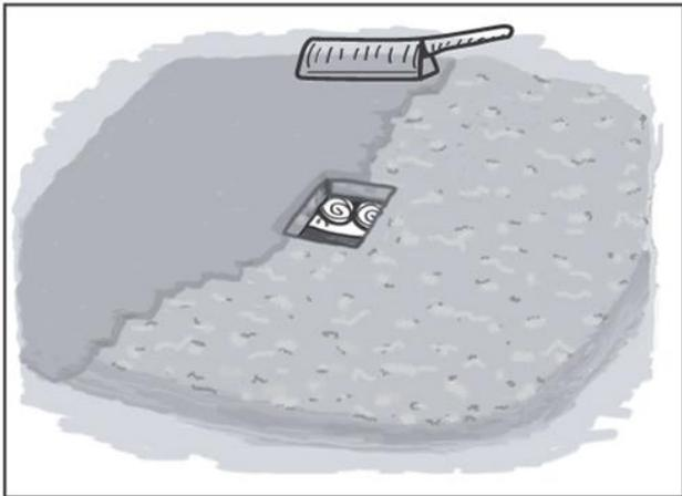
Pour terminer, on réalise une surface imperméable et lisse en compactant le dessus avec de la terre latéritique mélangée à de la bouse de vache ou à une décoction de cosses de néré. Certains utilisent simplement la terre des fourmières.
